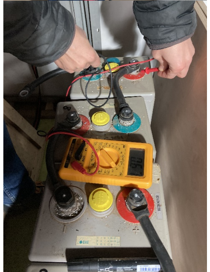
Batteriespannung checken Multimeter
