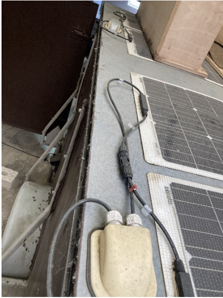
Dachmodulverschaltung
